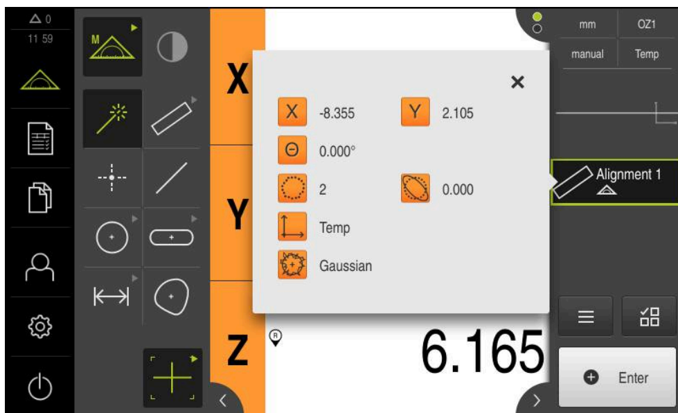
Figura 42: Elemento Alineación en la lista de elementos con Vista previa del elemento
